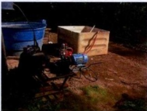
Local de preparo de agrotóxicos, com motor a combustão, cujas transmissões de força encontravam-se sem qualquer proteção.
