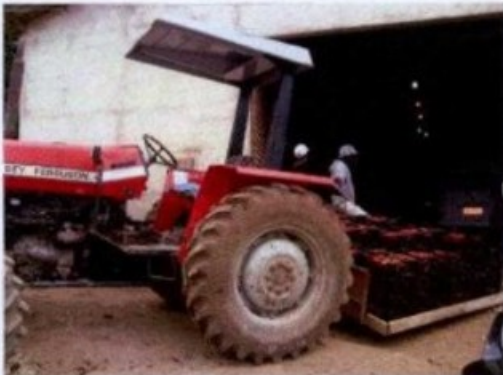
Trator utilizado para transporte de morangos da lavoura até o galpão, em precário estado de conservação, sem diversos acessórios exigidos em lei e operado por trabalhador sem habilitação e sem capacitação.
