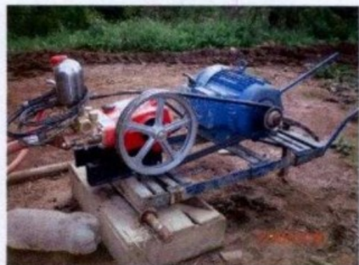
Local de preparo de agrotóxicos, com motor a combustão, cujas transmissões de força encontravam-se sem qualquer proteção.
