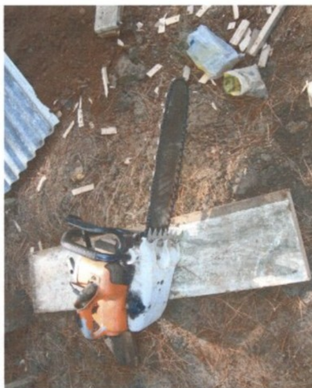
Motosserra sem dispositivos de segurança obrigatórios, utilizada por trabalhador sem treinamento.
