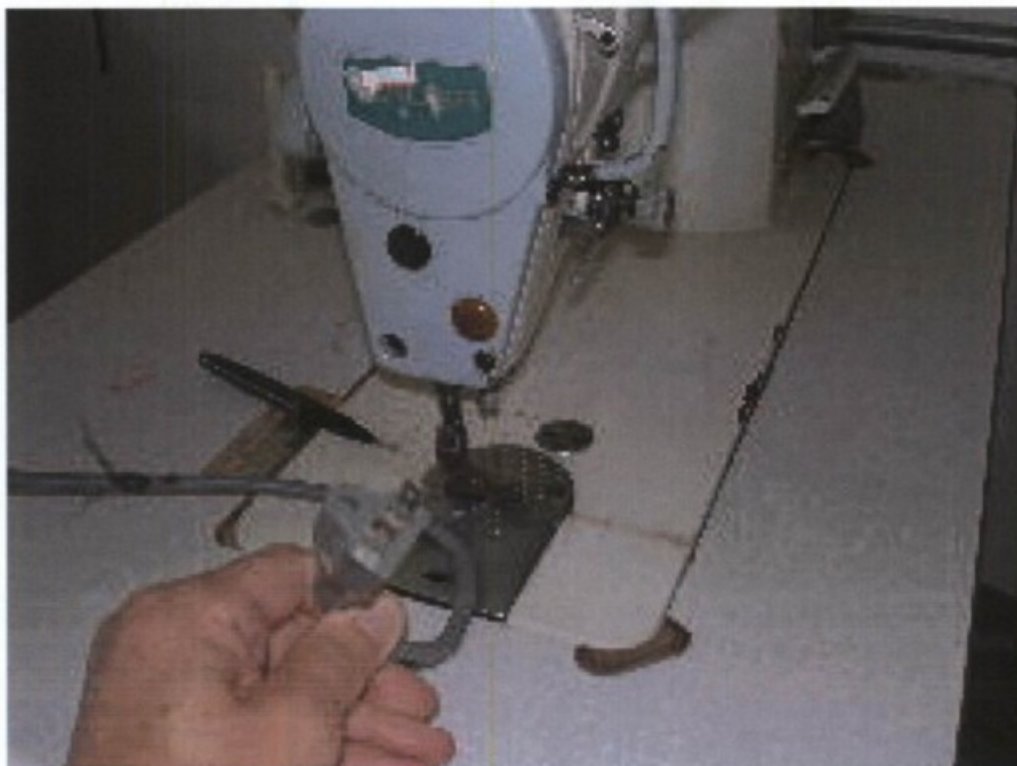
Imagem 71 - Oficina Sr. [REDACTED] - Indústria e Com de Roupas GSV Ltda ME ("gato" Sr. [REDACTED] - 18/2/2010 - Deixar de executar o aterramento das instalações elétricas conforme regulamentação estabelecida pelos órgãos competentes.
