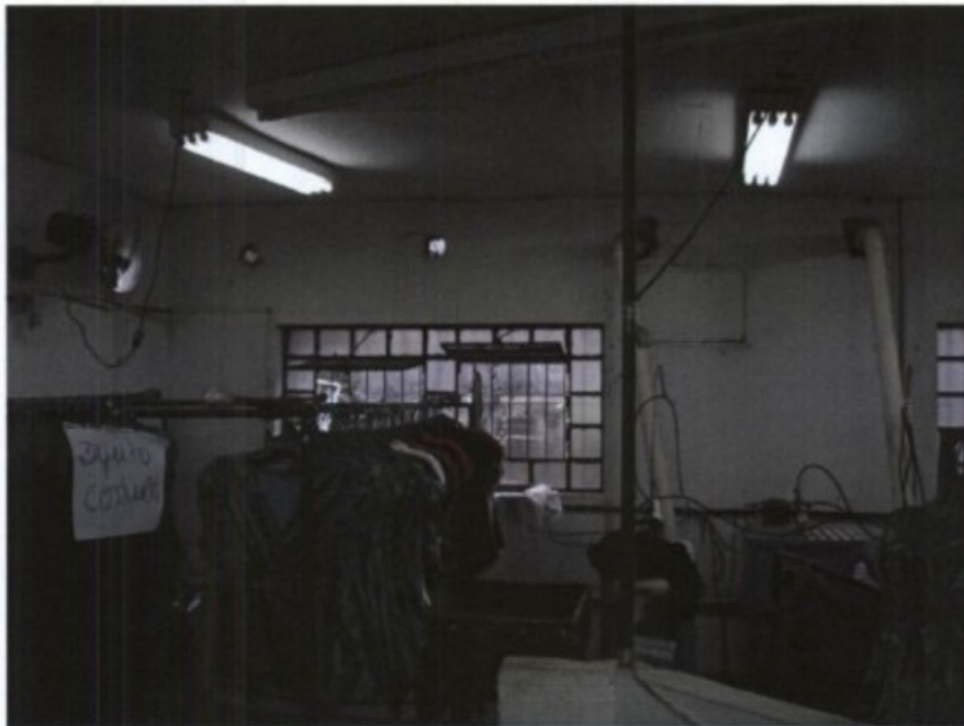
Imagem 41 - Bom Retiro- local de trabalho n. 4 – 22/02/2010 - Deixar de manter as condições de iluminação de acordo com o previsto na NR-17 e outras normas regulamentadoras.
