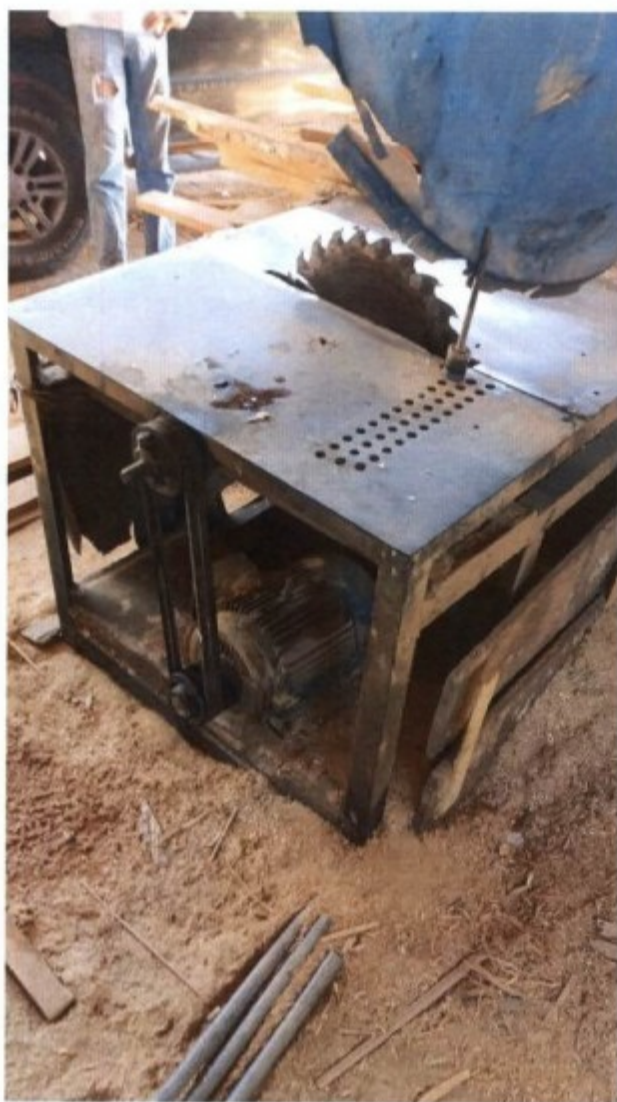
Serra circular sem proteção na fábrica de caixas.
