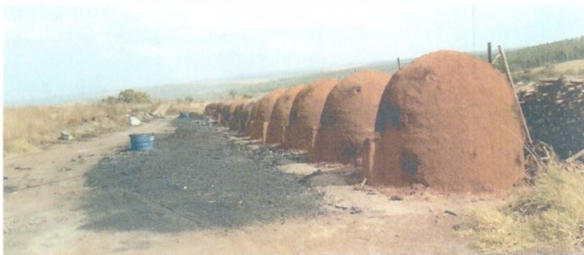
Foto 1 – Carvoaria da Sra. [REDACTED] com uma bateria de 23 fornos de produção de carvão de eucalipto.
