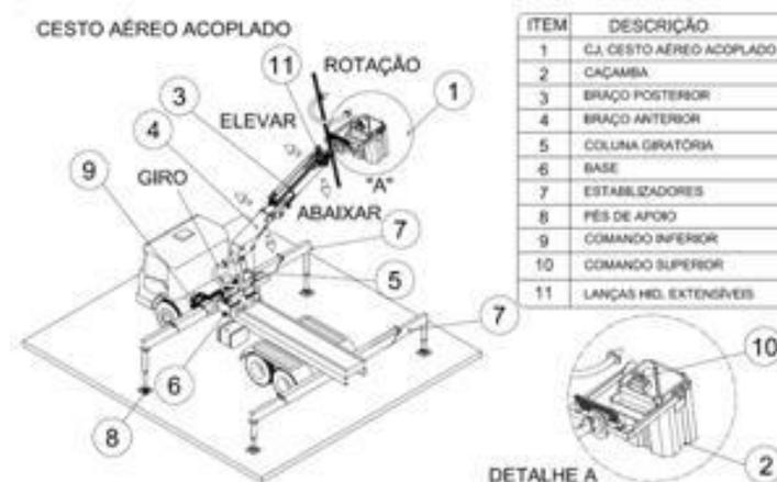
Figura 1: Exemplo de arranjo com cesto acoplado
