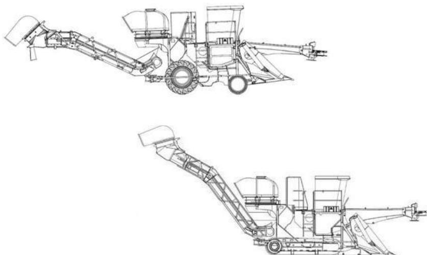
**Colhedora de forragem ou forrageira autopropelida:** equipamento agrícola automotriz apropriado para colheita e forragem de milho, sorgo, girassol e outros. Executa o corte da planta, sendo capaz de colher ou recolher, triturar e recolher a cultura cortada em contentores ou veículos separados de transbordo.
