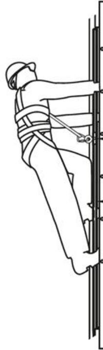
**Figura 10. Exemplo de sistema baseado em linha de ancoragem vertical rígida instalada de forma permanente. Fonte: NBR 16489**
