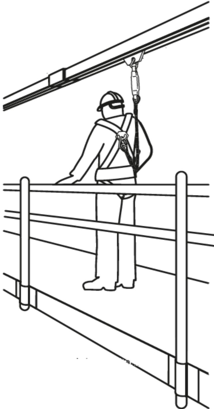
Figura 44. Tipo D – Exemplo de linha de ancoragem rígida horizontal. Fonte: NBR 16489
