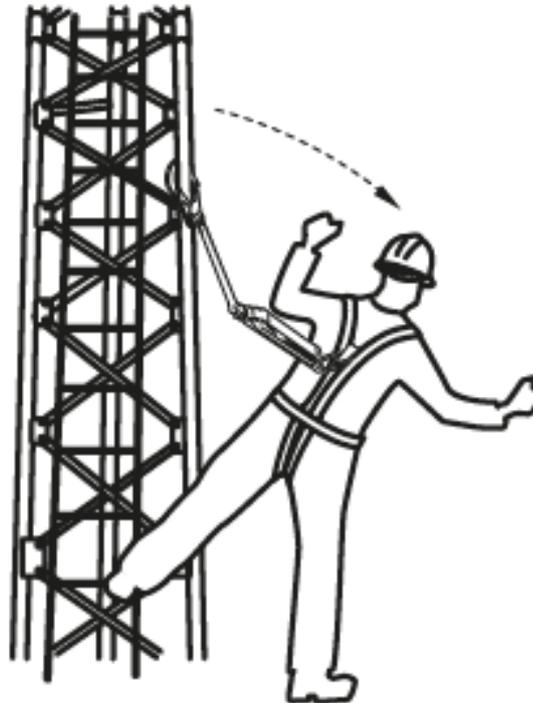
Figura 36. Sistema de ancoragem composto unicamente pela estrutura. Fonte: NBR 16489
