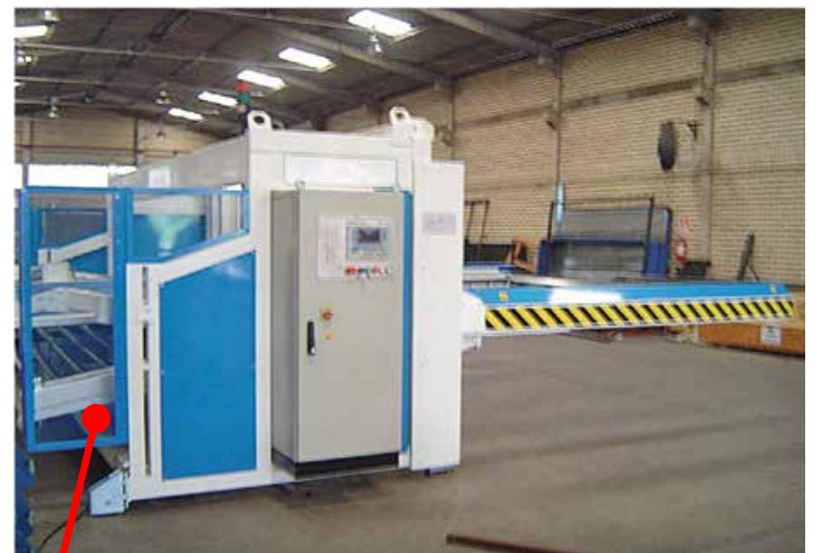
Proteção fixa na lateral da máquina
