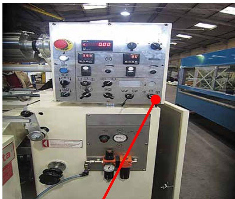
Chave seletora utilizada na manutenção e limpeza dos rolos da máquina. Quando acionada, a máquina realiza movimentos com velocidade inferior a 10mm/s
