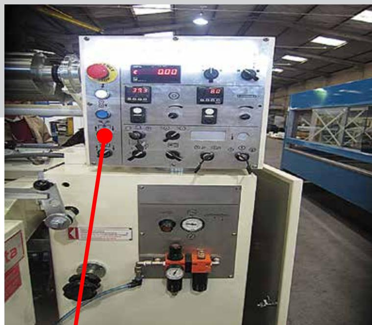
Dispositivo de ação continuada para realizar a troca do cilindro
