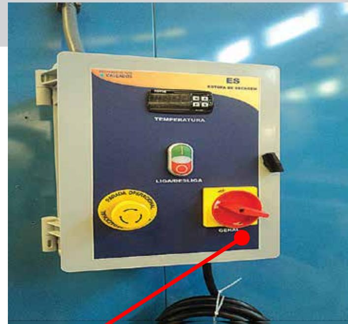
Chave seccionadora que permite o bloqueio
