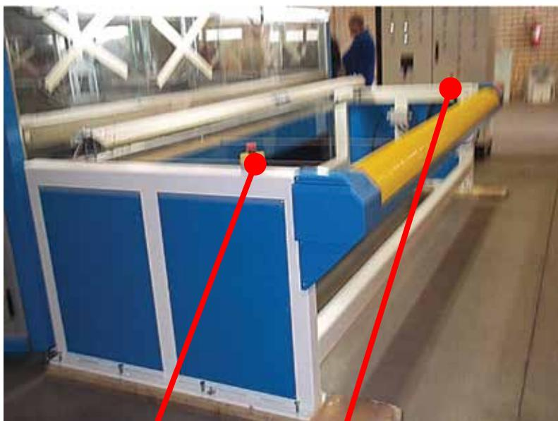
Botão de emergência monitorado por interface de segurança. Quando acionado, interrompe todos os movimentos da máquina
