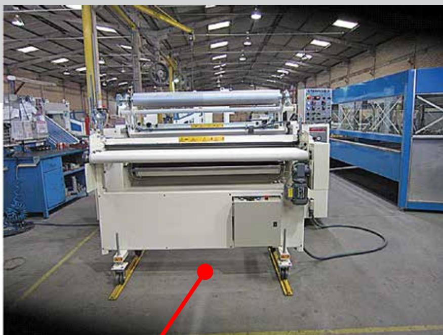
No vão existente entre os trilhos, deve existir um estrado com altura não inferior ao nível superior do trilho (esta informação deve constar no catálogo da máquina)
