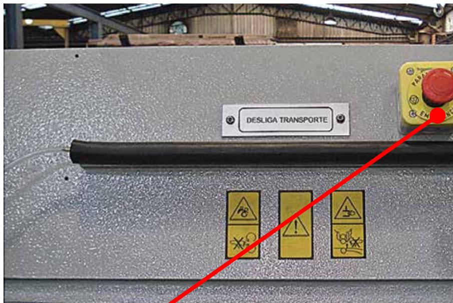
Botão de emergência monitorado por interface de segurança do cabeçote. Quando acionado, desliga o motor da bomba hidráulica, subindo o cabeçote da máquina, desligando a navalha, o transporte e os afiadores
