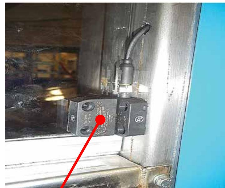
Sensores magnéticos das proteções móveis, que, quando acionados, interrompem o movimento das pistolas e da esteira
