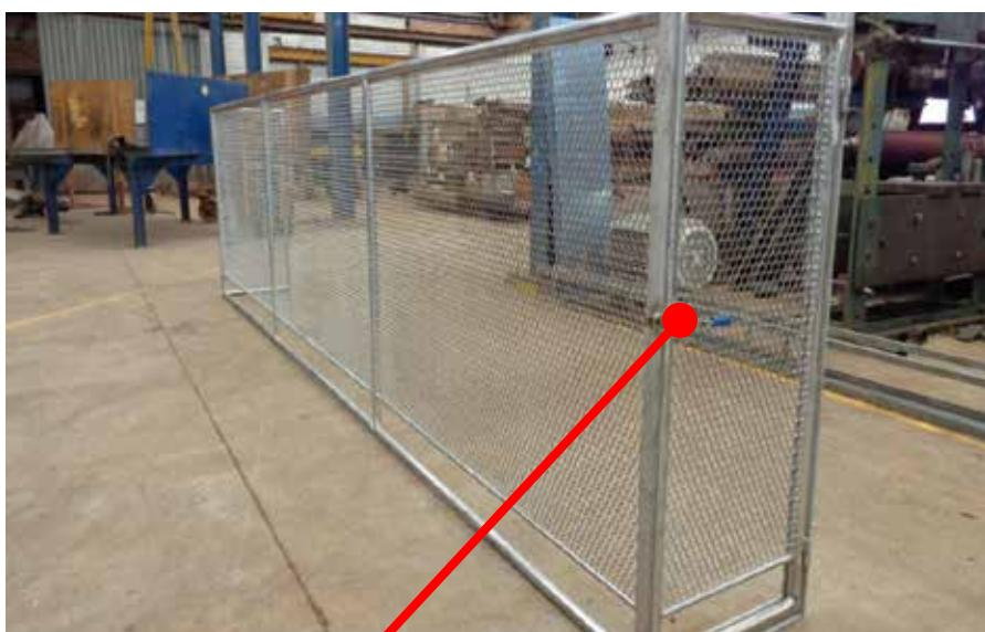
Proteção fixa (na parte posterior) com porta intertravada. Quando a porta é aberta, desliga a bomba, abre a máquina, desliga o movimento do cilindro de navalhas, fecha a proteção articulada e desliga o afiador
