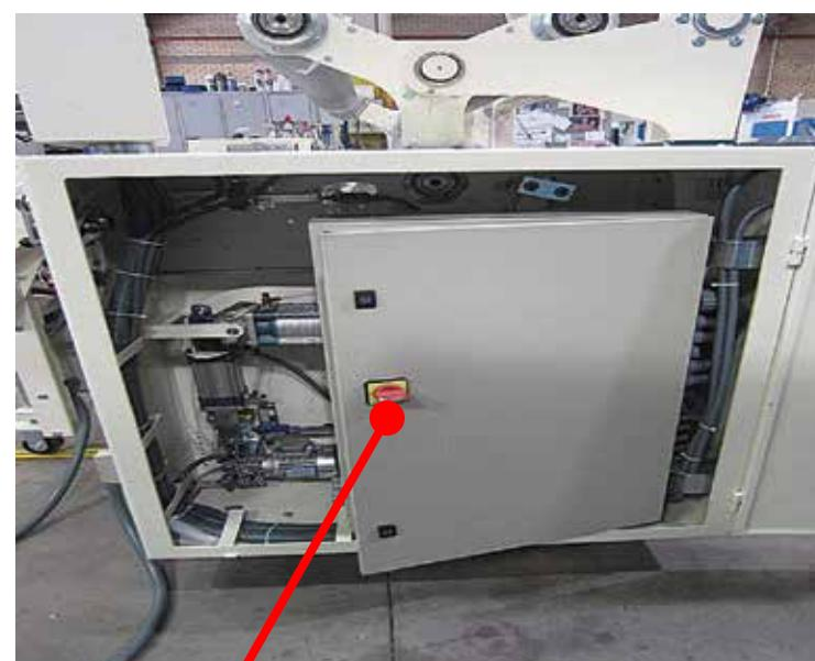
Chave seccionadora que permite o bloqueio
