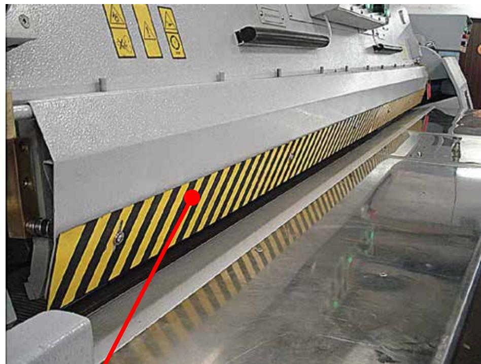
Proteção móvel intertravada que, quando acionada, sobe o cabeçote da máquina, desligando a navalha, o transporte e os afiadores
