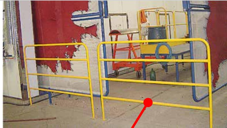
Proteção fixa que impede o acesso aos quadros em movimento, em todo o perímetro da máquina, conforme a figura 1 (página anterior)
