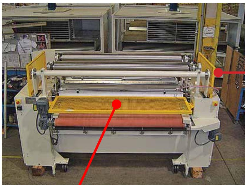
Proteção fixa superior da área de aplicação de tinta na parte traseira
