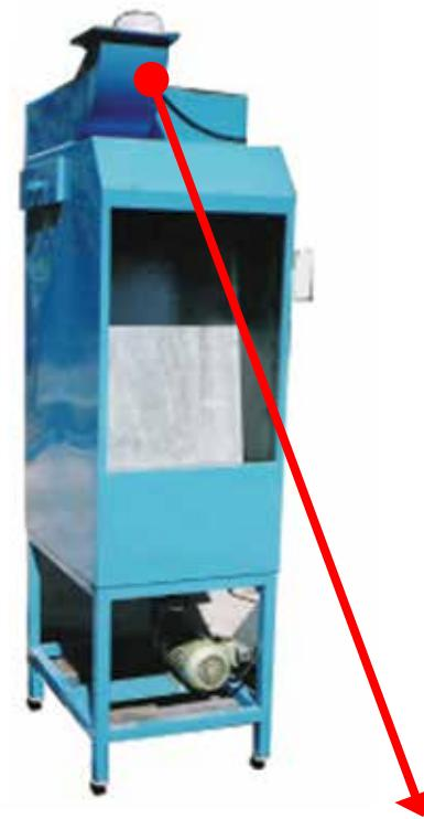
Proteção fixa que impede o acesso do operador e de terceiros ao ventilador
