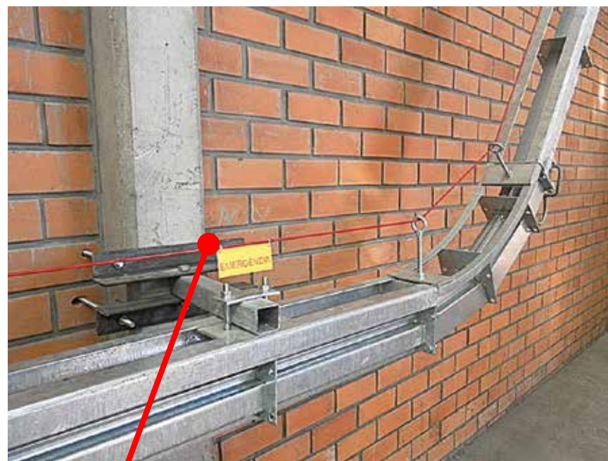
Cabo de emergência que deve ser instalado em pontos onde o transportador estiver em altura inferior a 2,5m em relação ao plano de trabalho
