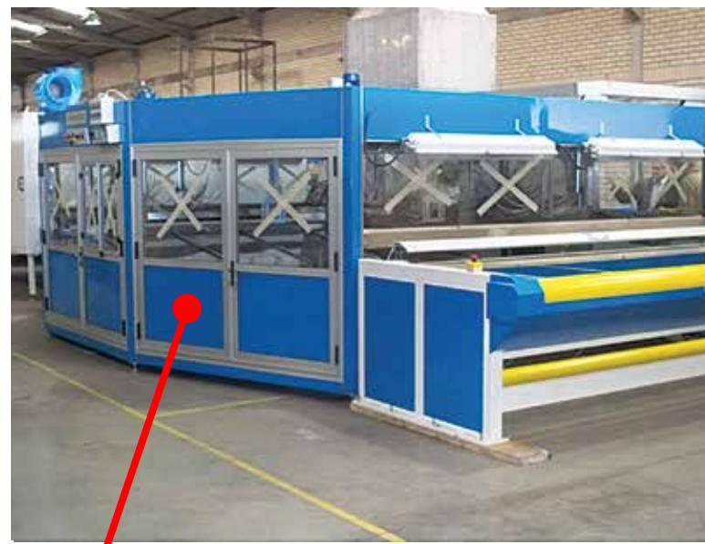
Proteção fixa no perímetro da máquina
