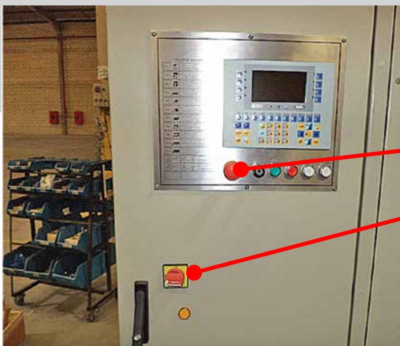
Botão de emergência monitorado por interface de segurança. Quando acionado, todos os movimentos da máquina são interrompidos
