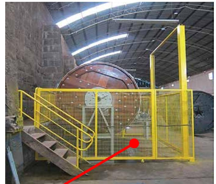
Proteção fixa nas laterais da máquina
