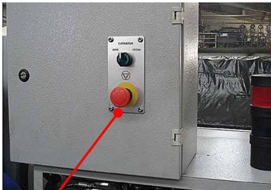
Botão de emergência monitorado por interface de segurança da parte traseira da máquina. Quando acionado, desliga o motor da bomba hidráulica, subindo o cabeçote da máquina, desligando a navalha, o transporte e os afiadores
