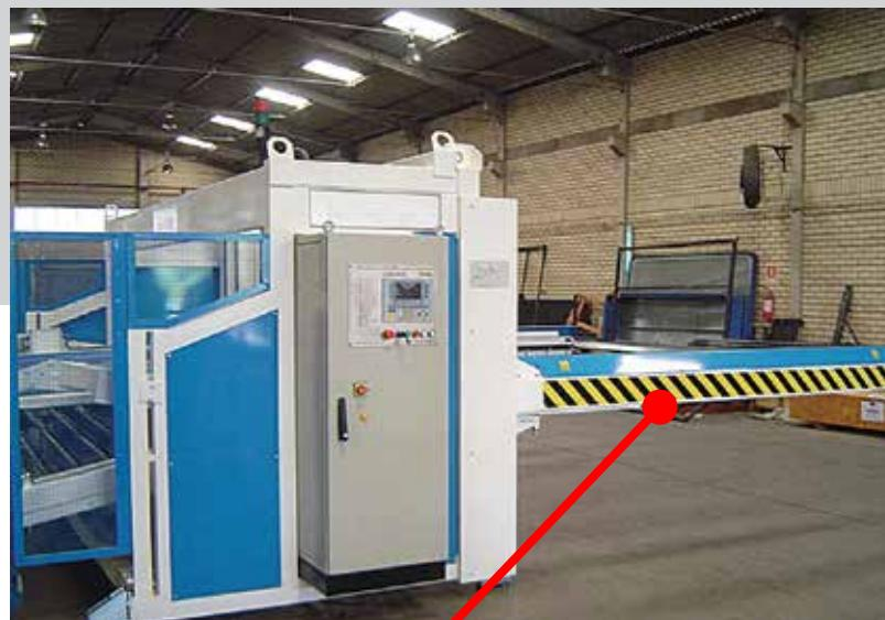
A área de retirada do couro deve ser acionada por um dispositivo de ação continuada
