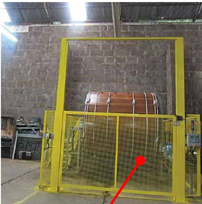
Proteção móvel intertravada com bloqueio, monitorada por interface de segurança na área de descarregamento
