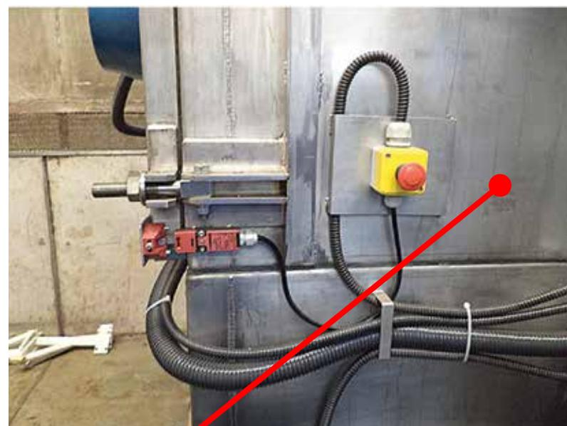
Proteção móvel intertravada através de chave de segurança monitorada por interface de segurança. Quando acionada, todos os movimentos de risco são interrompidos
