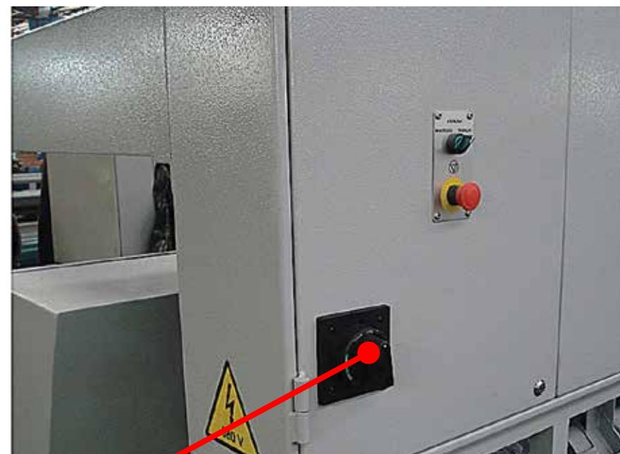
Chave seccionadora que permite o bloqueio
