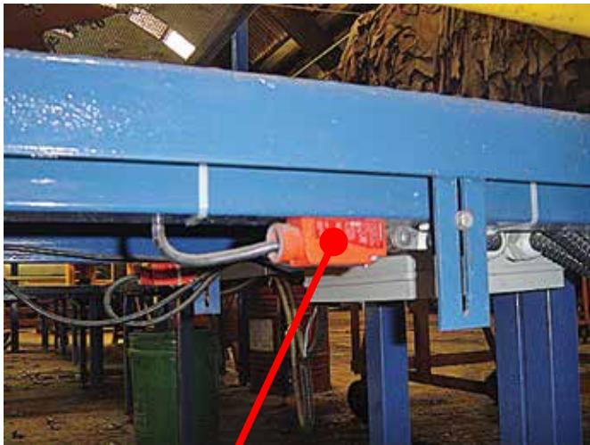
Dispositivo de intertravamento da plataforma monitorado por interface de segurança. O acionamento do sistema interrompe o movimento dos quadros
