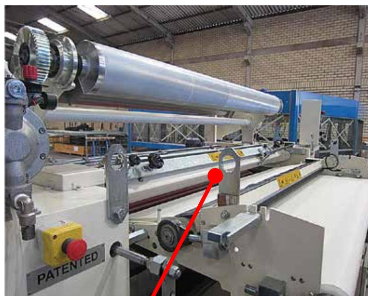
Pontos de içamento para transporte da máquina
