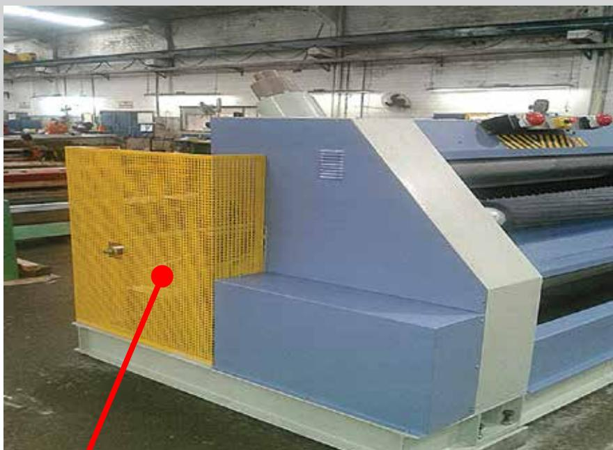
Proteção fixa da parte lateral da máquina
