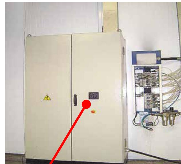
Botão de emergência monitorado por interface de segurança. Ao ser acionado, interrompe todos os movimentos da máquina, desenergizando-a
