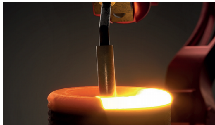
Figura 8 – Detalhe do acúmulo de calor no processo.
