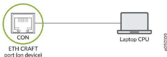
Figura 39: Conectando a Série QFX diretamente a um console de gerenciamento
