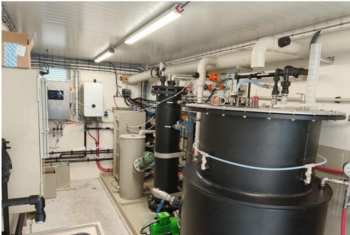
Figura 2: Digestor piloto com o biorreator anaeróbico de 500L.
