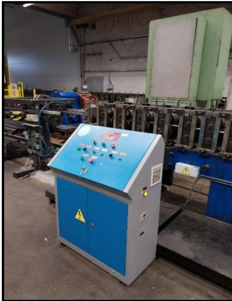
Figura 6 – Vista geral do painel elétrico e de comando com CLP
