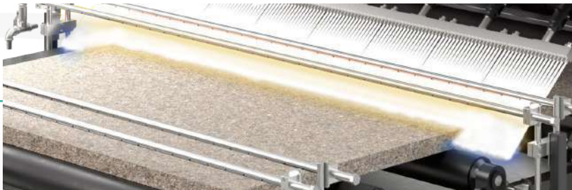
Bicos de flamejar múltiplos e sistema de arrefecimento Multi Fire Nozzles and water cooling system
