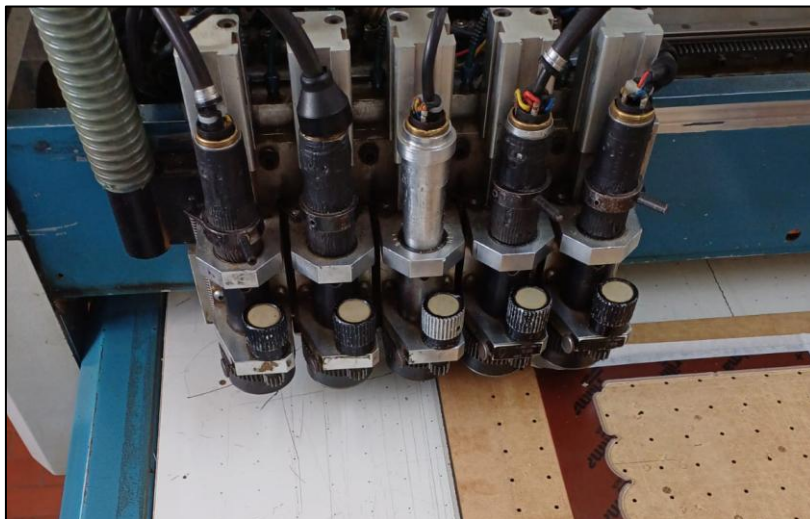
Foto 2 - Vista detalhada das 05 (cinco) cabeças de fresagem.
