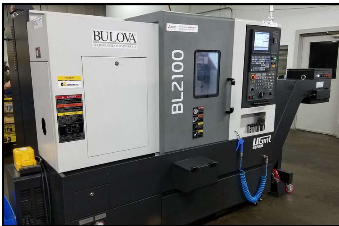
Vista do centro de torneamento horizontal para trabalhar peças metálicas, modelo: BL2100.
