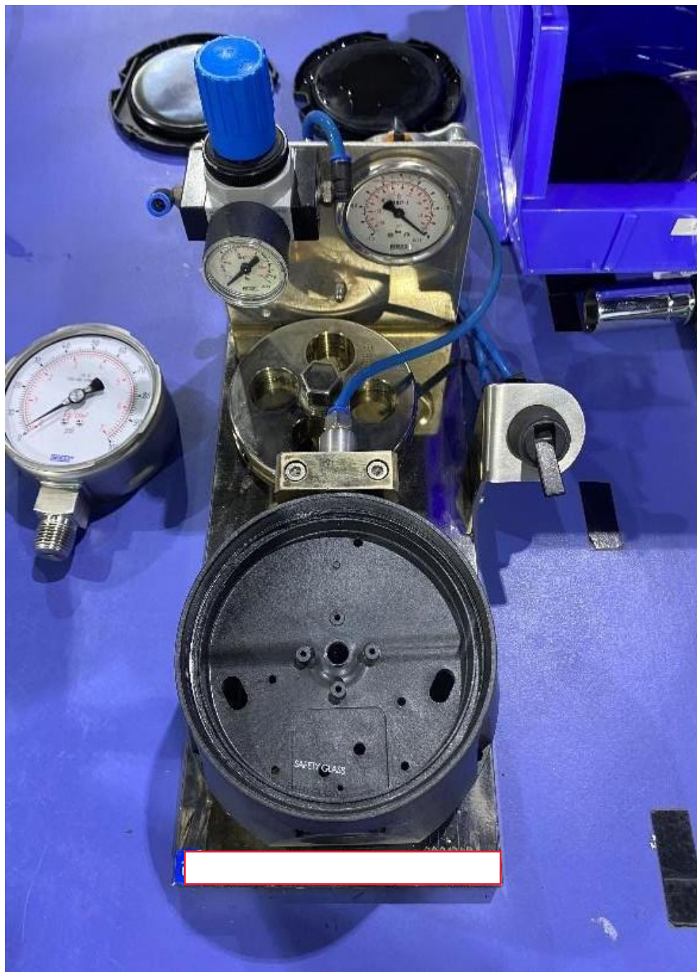
Foto nº 01 – Vista geral do Dispositivo de montagem, por meio da aplicação de vácuo, do visor de vidro e vedação de borracha na caixa (ou invólucro) com diâmetro de 4,5 polegadas, fabricada em polibutileno tereftalato (PBT) reforçada com fibra de vidro e usada em manômetro com tubo Bourdon.
