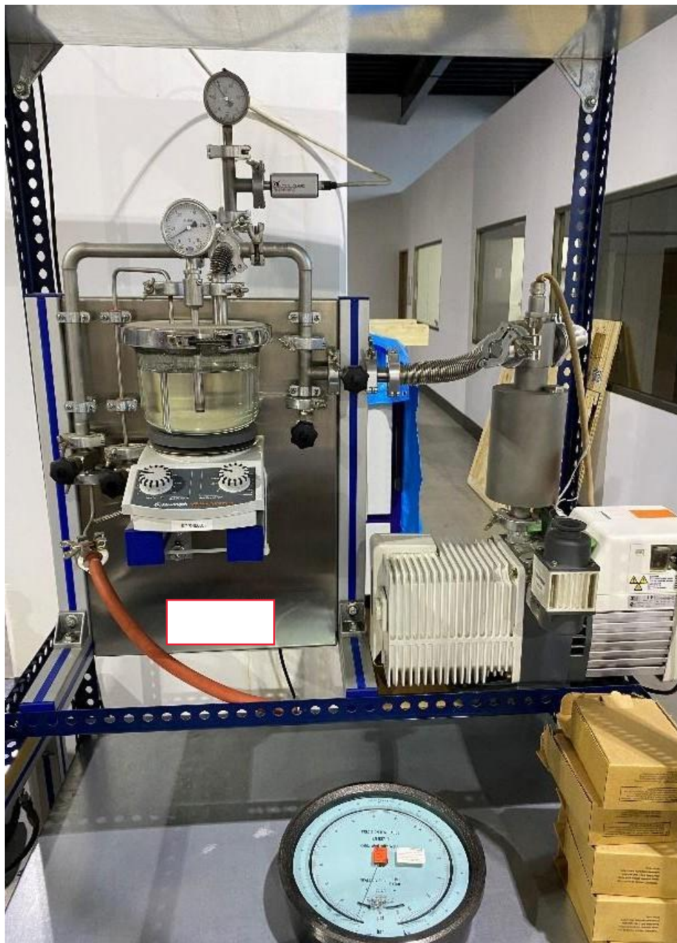
Foto n° 01 – Vista geral da máquina automática para enchimento, com silicone ou glicerina, do sistema formado por manômetro com tubo Bourdon e selo diafragma.
