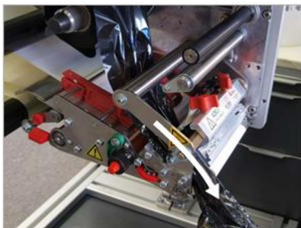
Imagem da cabeça de impressão termal (Fig.4)
