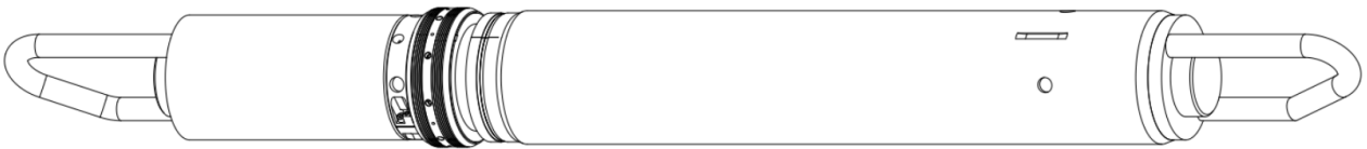
Figura 1: Invólucro A-HEHC-KDB com capas superiores e inferiores
