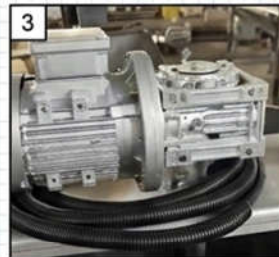
3. Conjunto do Motor e Engrenagens s. Motor elétrico trifásico e caixa de engrenagens de redução de velocidade.
