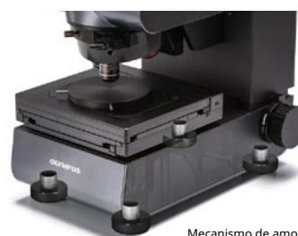
Mecanismo de amortecimento de vibração híbrido
