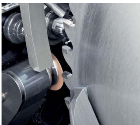
Mecanização do canal quebra cavaco.
