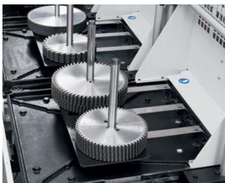
Duas pilhas de serras sobre um carrinho de carga para aumentar a capacidade de carga.
