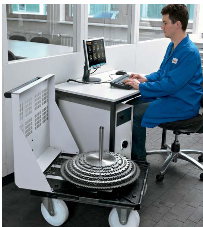
As pilhas de serras são preparadas e programadas por meio de uma estação de introdução de dados desenhada para o uso em ambientes de trabalho.
