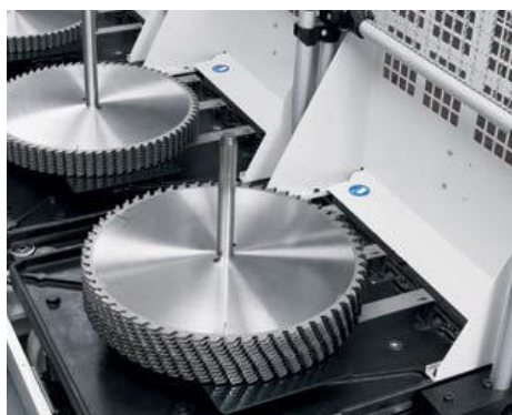
Carrinho de carga com uma pilha de serras no modo de produção.
