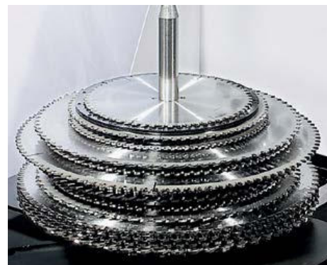
Em cada carrinho de carga podem ser empilhadas até 50 serras circulares com diferentes diâmetros e geometrias de dente.
