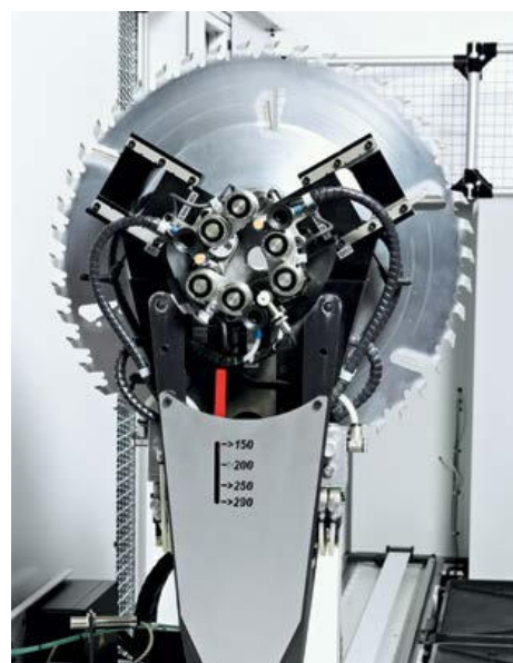
Braço especialmente desenhado para serras com corpo escalonado. Pode ser montado em ambos os sistemas de carregamento.
