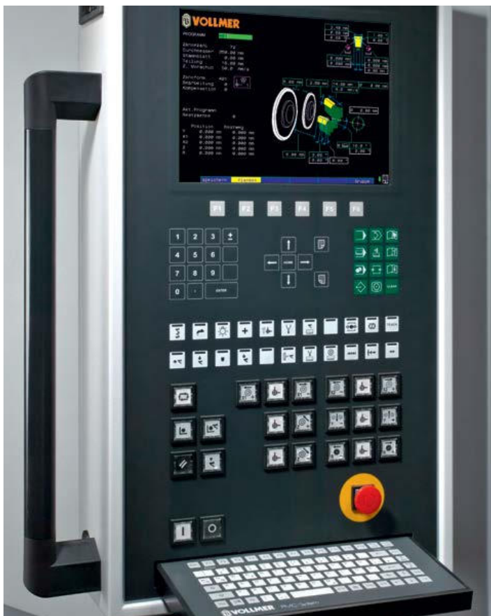
Tela de entrada para a medição do dente.
