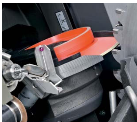
Mecanização do peito com ângulo negativo.
