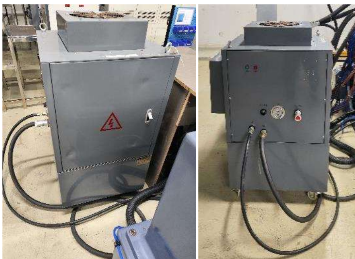
Figura 6: Unidade de pressão de óleo (frente e fundo)
