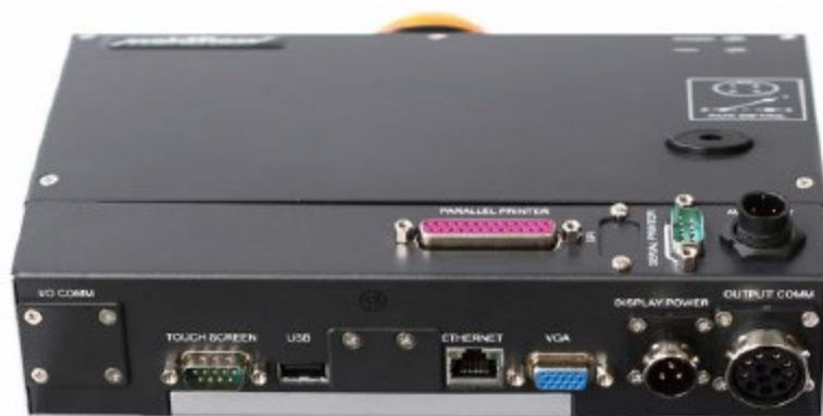
Figura 16-4 Figura 15: Microcaixa do Matrix – Detalhes de conexão
