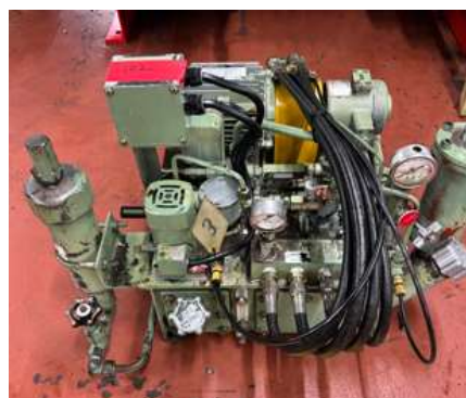
Unidade Hidráulica – disposta na parte traseira da máquina
