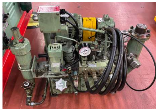
Unidade Hidráulica – disposta na parte traseira da máquina
