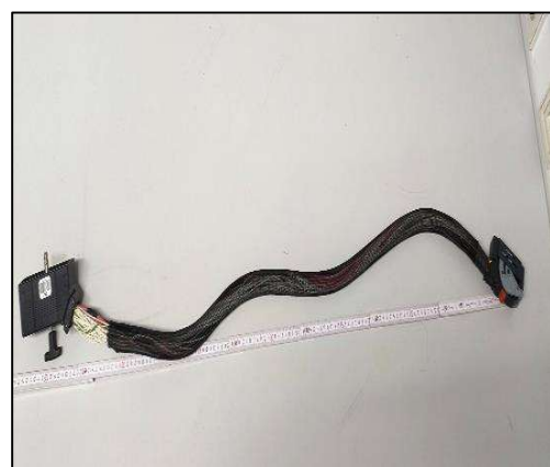
Figura 6 - Cabos de conexão do LabCar ao módulo EHCU
