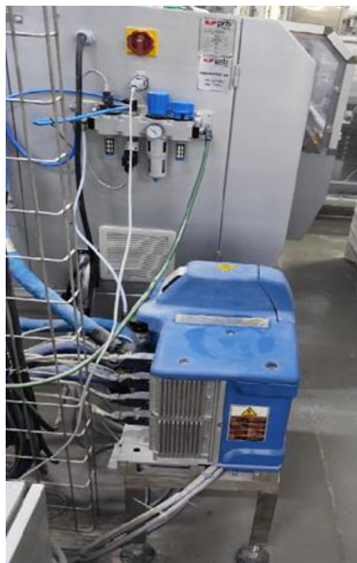
Figure 6- Coleiro Nordson Hot-Melt e entrada para alimentação de Ar comprimido
