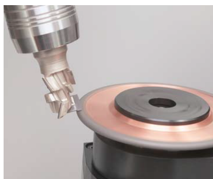
Retificação de alívio de uma fresa de topo na face
