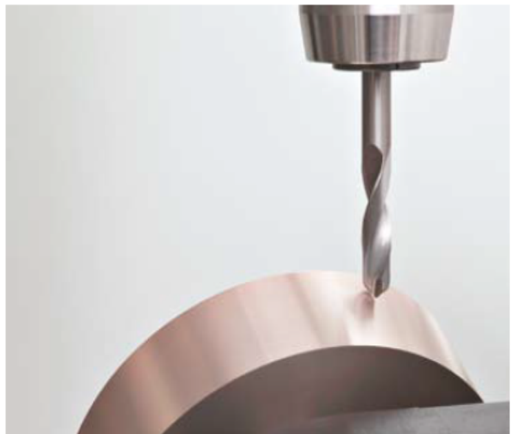
Eletroerosão da aresta de corte principal de uma broca PCD com o novo pacote de software – sem problemas
