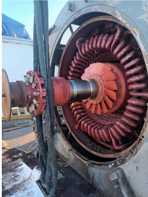
Gerador Elétrico e Rotor da Excitatriz
