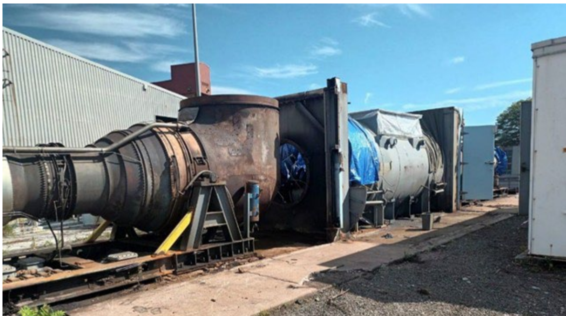
Grupo Eletrogêneo – Turbina "A" a esquerda e Gerador a direita
