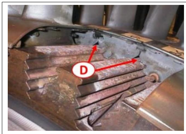
Encaixe das palhetas, da esquerda após a manutenção, da direita antes da manutenção
