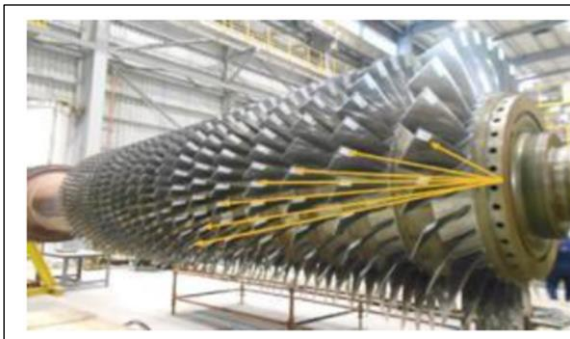
Turbina removida da Carcaça
