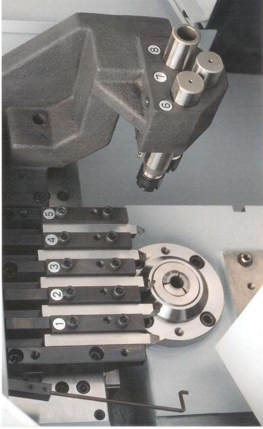
Torno CNC Automático Tipo Suíço
