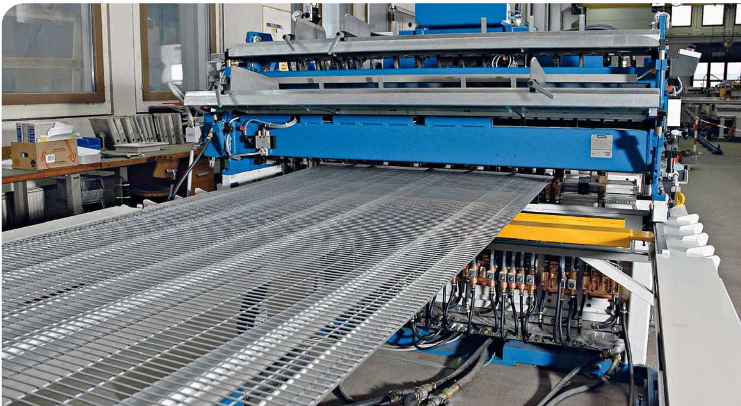
Produção de cerca com arame pré cortado
