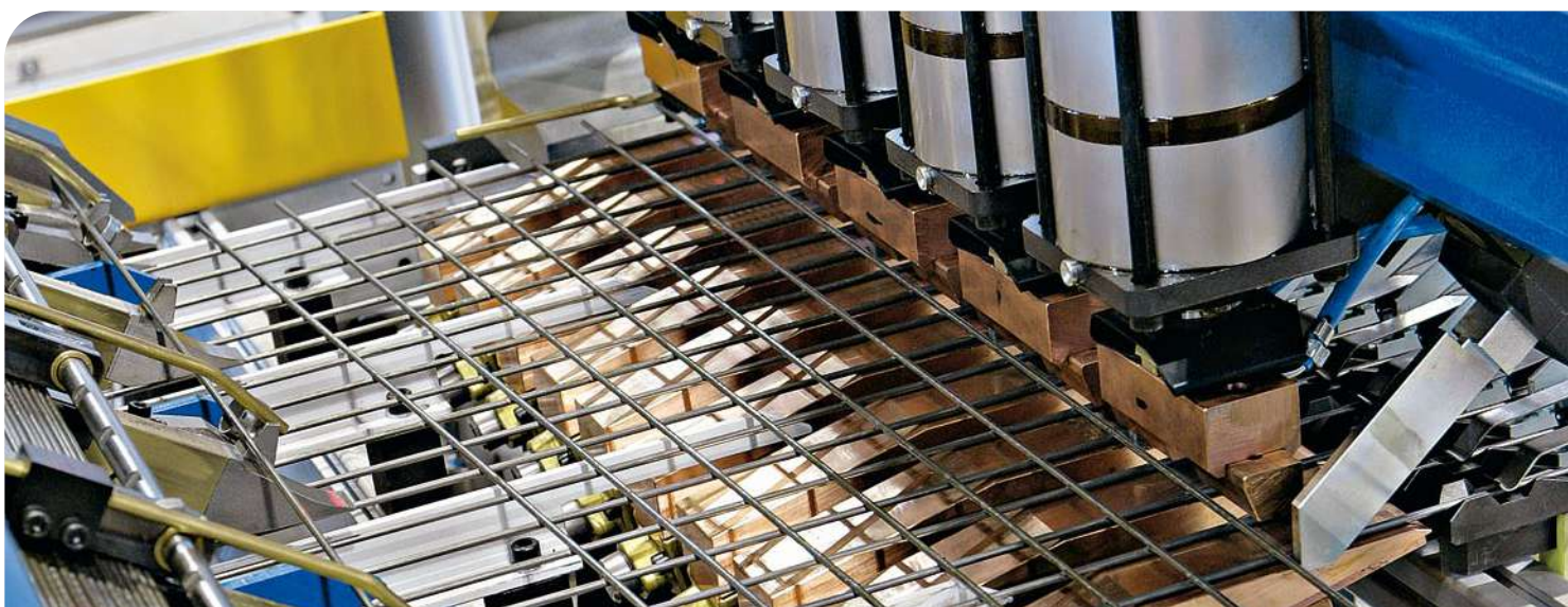
Portal de solda com programação de extração
