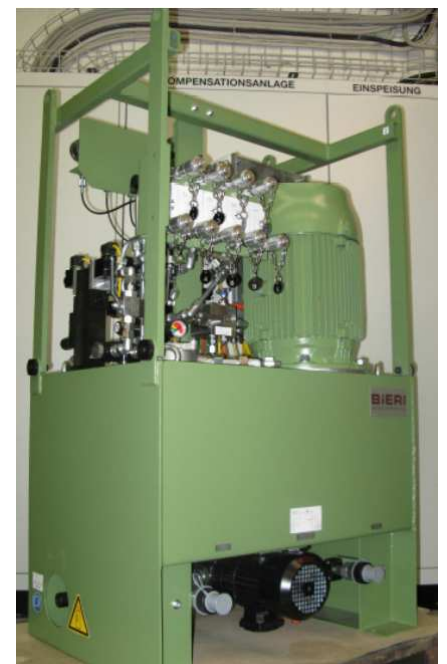
Traseira da Unidade Hidráulica, com as saídas para engate rápido
