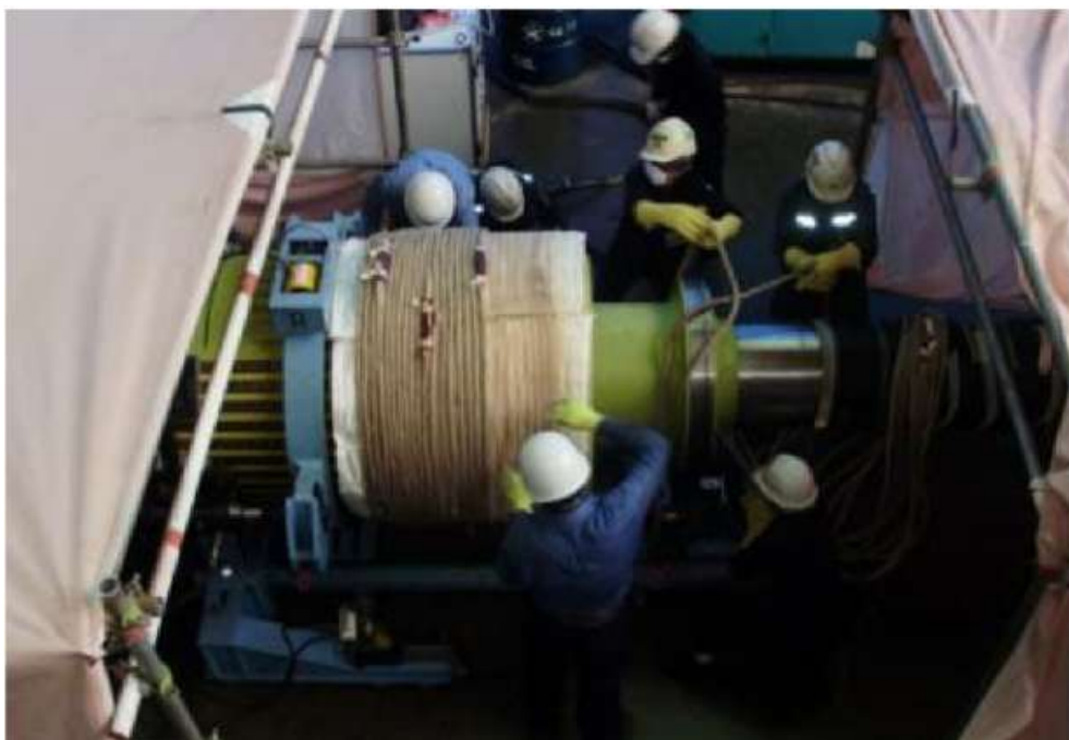
Preparação para aquecimento e remoção do anel retentor
