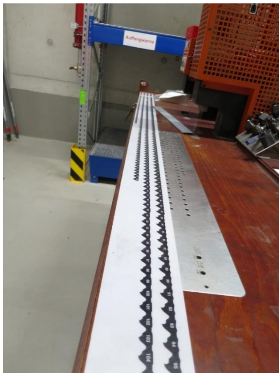
Foto n° 02 – Vista do dispositivo com régua de seccionamento, que é utilizado pela máquina modelo NG3 para determinação do “loop” (ou comprimento definido) de cada corrente.
