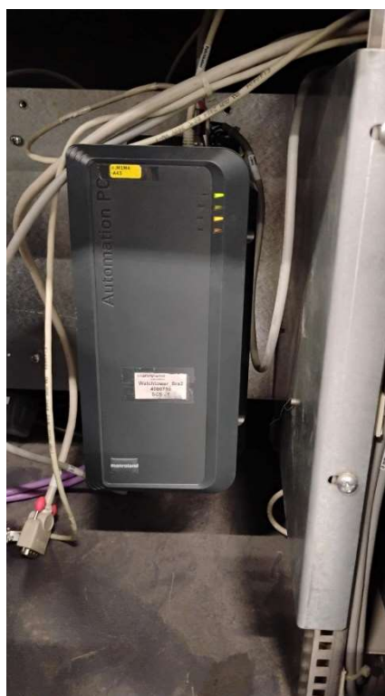
PCs Industriais instalados na impressora rotativa Manroland Lithoman IV
