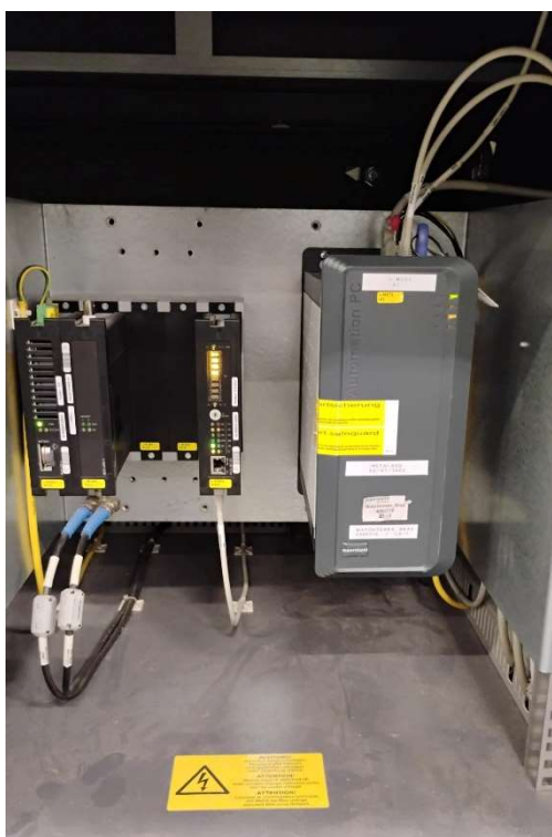
PCs Industriais instalados na impressora rotativa Manroland Lithoman IV
