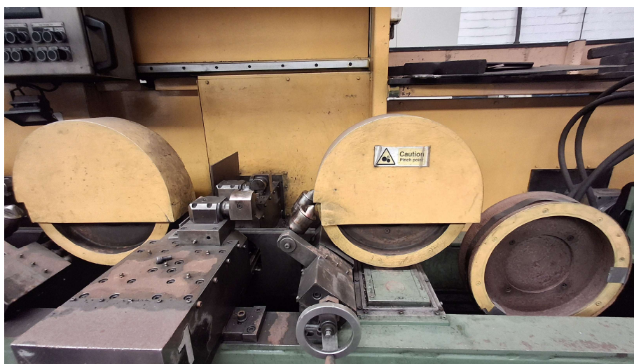
Figura 5- Cabeçote de usinagem + Guias centralizadora + rolos tensionadores
