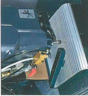
Dispositivo de detecção de quebra de ferramenta A quebra de ferramenta é detectada durante a troca de ferramenta, reduzindo o tempo de deteção.
