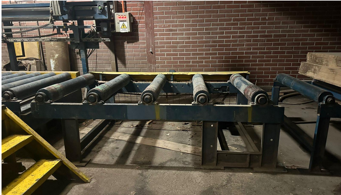
figura 2: Segunda camada de roletes motorizados
