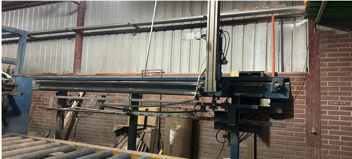
figura 4: braço empurrador de painel pneumático
