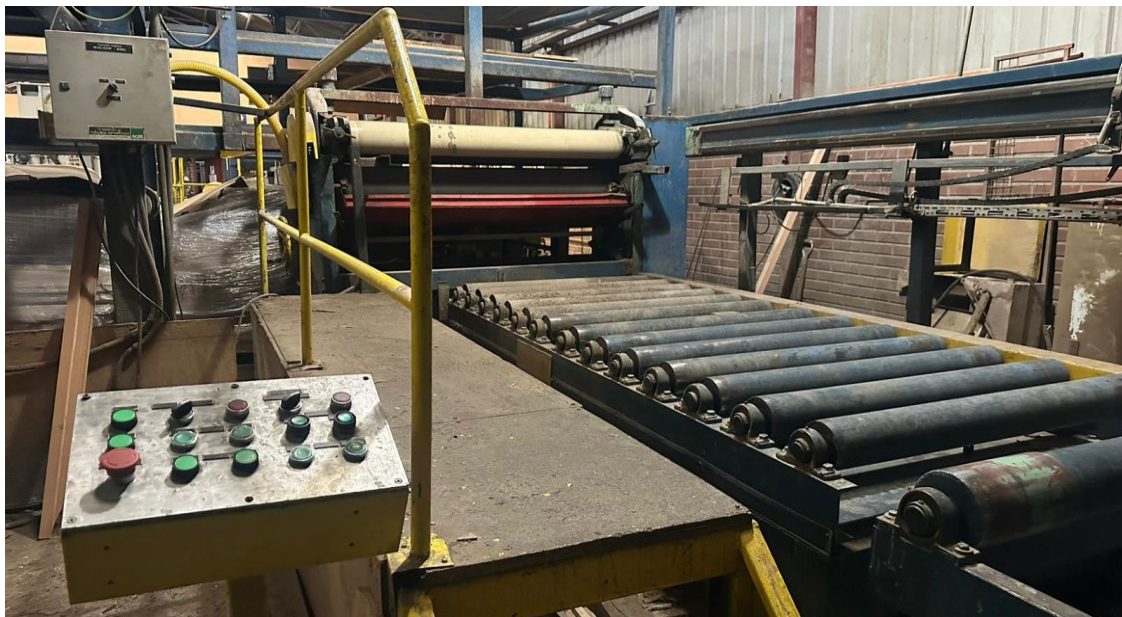
figura 3: Terceira camada de roletes motorizada com bomba hidráulica
