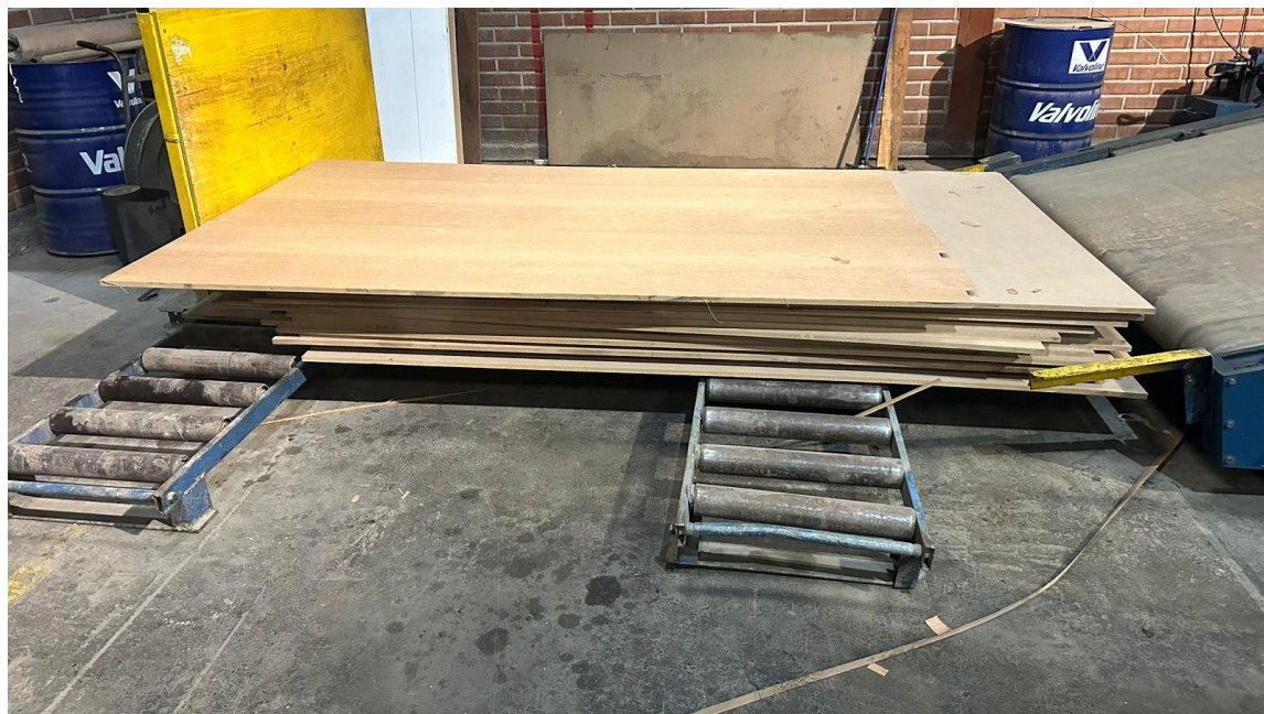
figura 10: Transportador de rolos metálicos para recebimento de painéis
