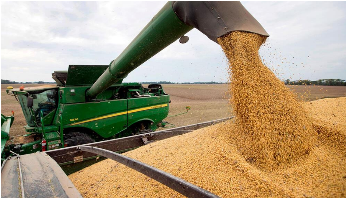
Imagem 2 – Colhedora debulhadora autopropulsionada para a colheita do milho seco
