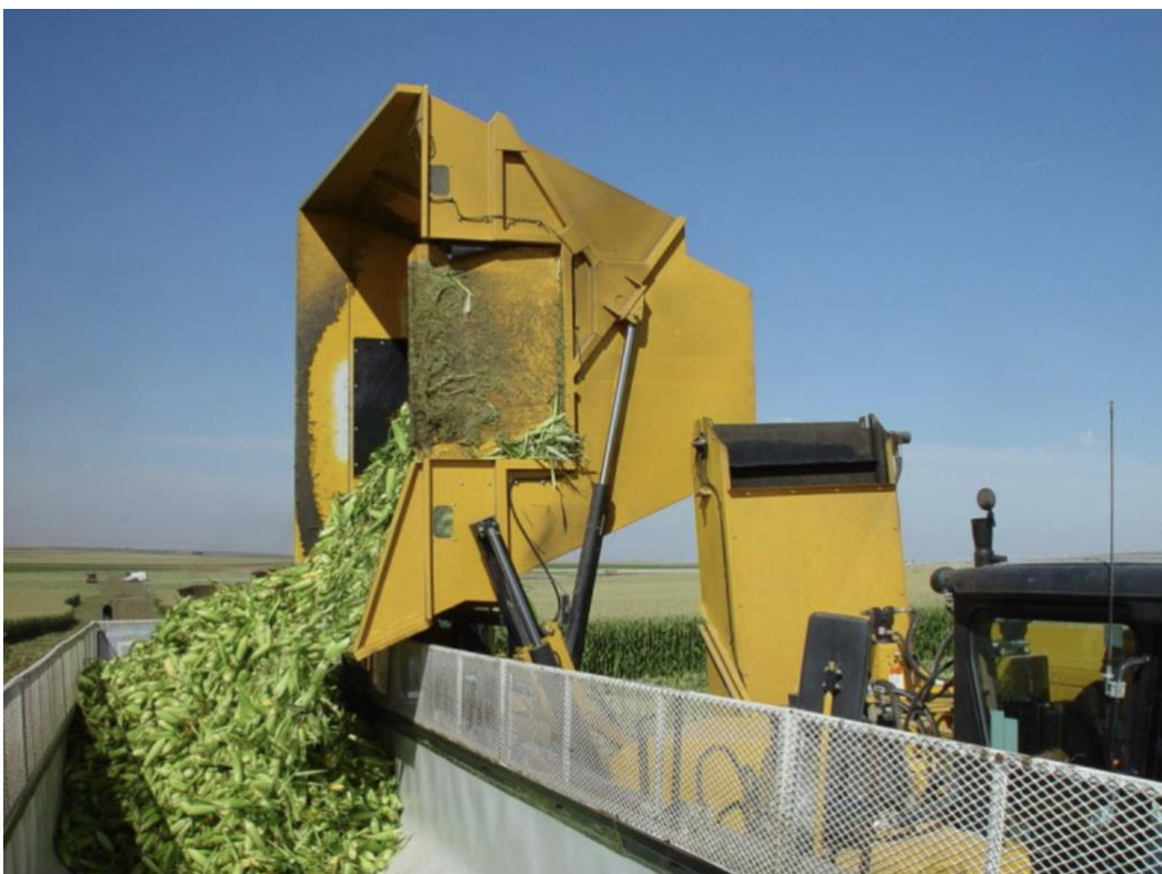
Imagem 5 – vista da caixa de armazenagem e despejo basculante, despejando espigas em esteira de entrada de unidade de beneficiamento.
