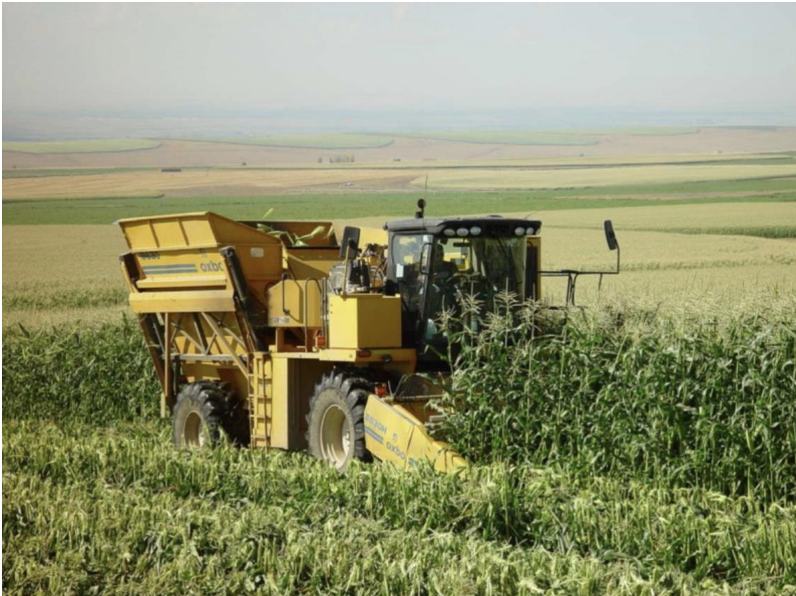
Imagem 4 – vista diagonal da colheitadeira realizando atividade proposta de colheita e armazenagem em caixa de armazenagem e despejo basculante, localizado na traseira.
