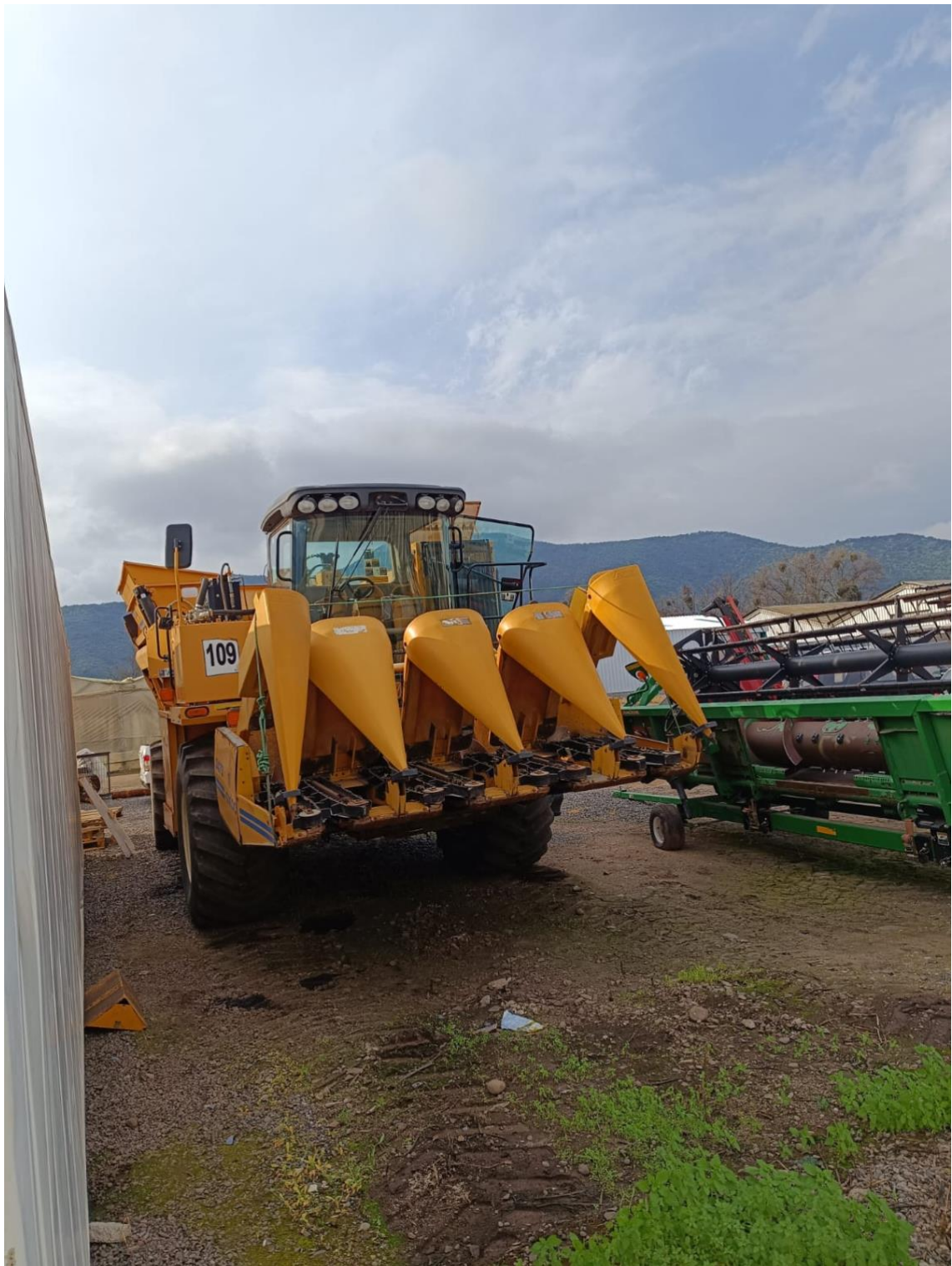
Imagem 3 – vista frontal da plataforma de colheita de 04 linhas
