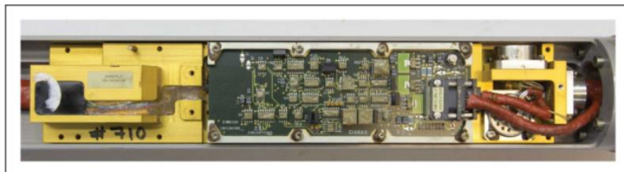
DHRU-FB instalado no chassi de um cartucho eletrônico.
