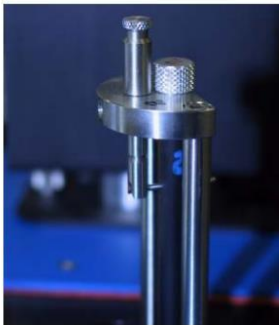
ROTOR COM PINO DE BLOQUEIO DO ROTOR NO LUGAR
