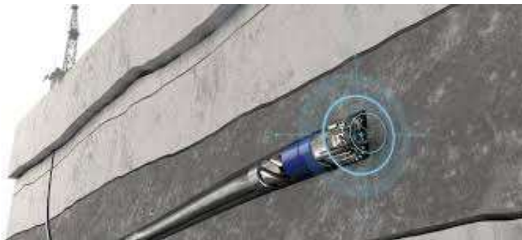
Figura Ilustrativa de aplicação do Motor de fundo – transmitindo rotação para broca e orientando trajetória no interior de uma formação rochosa específica.
