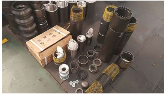
Foto ilustrativa: Esquerda – Parte Baixa (ou Lower end) do Motor, sendo a vista externa e sem as partes internas. Direita - Partes internas que compõem o Lower end antes de enviar a poço.
