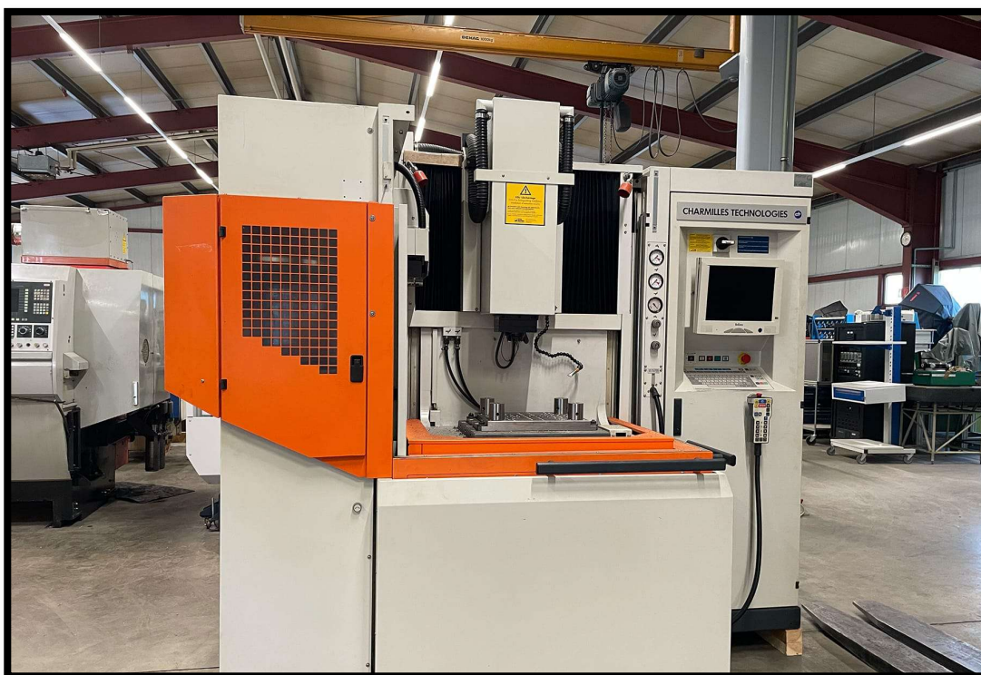
Vista da máquina de usinagem por eletroerosão, por penetração, de peças metálicas, modelo: Roboform31.
