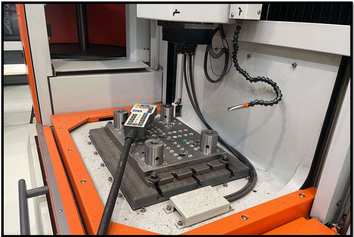
Vista detalhada da zona de operação da máquina de usinagem por eletroerosão, por penetração.
