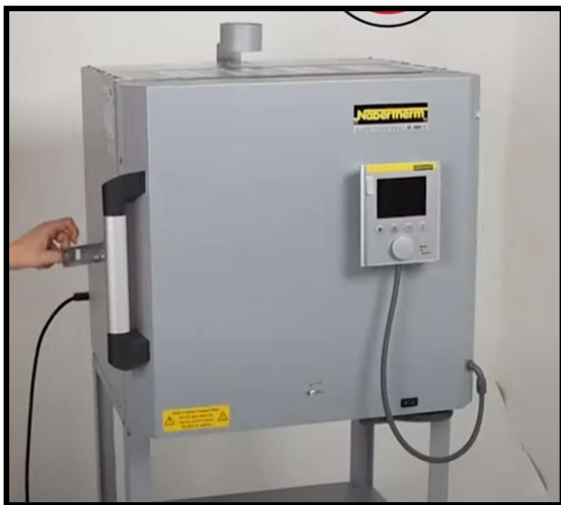
Vista detalhada do forno de aquecimento direto por resistência elétrica, modelo: N40E.
