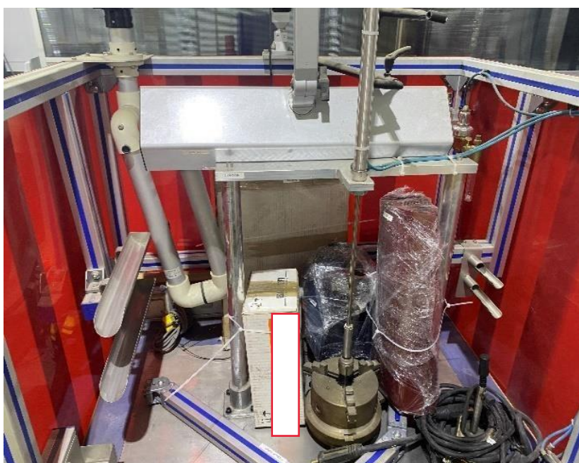
Foto n° 01 – Vistas da estação de soldagem de selo diafragma de aço inoxidável em manômetros, transmissores de processo, pressostatos e sensores de pressão.
