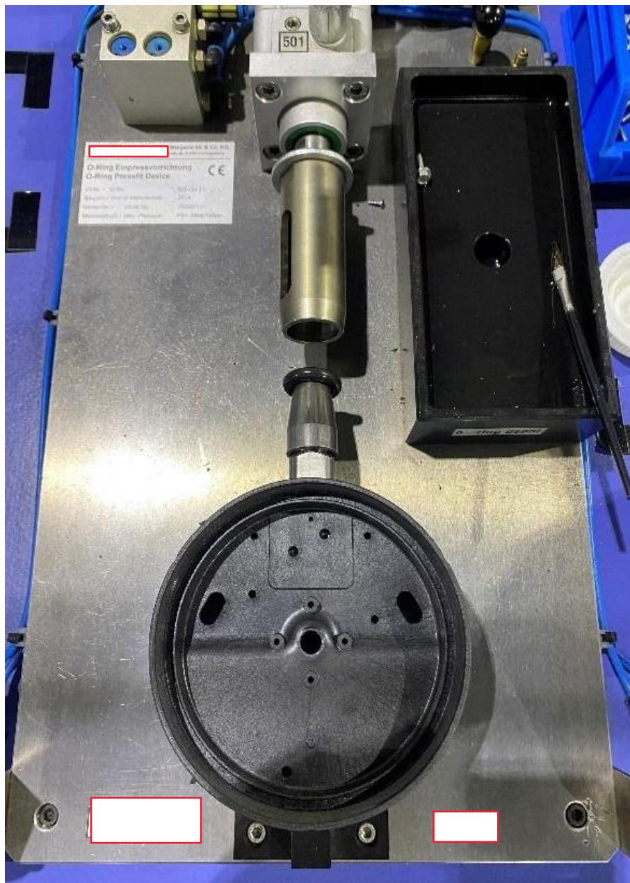
Foto nº 01 – Vista geral do dispositivo pneumático de montagem do anel de vedação de borracha na caixa (ou invólucro) com diâmetro de 4,5 polegadas, fabricada em polibutileno tereftalato (PBT) reforçada com fibra de vidro e usada em manômetro com tubo Bourdon.
